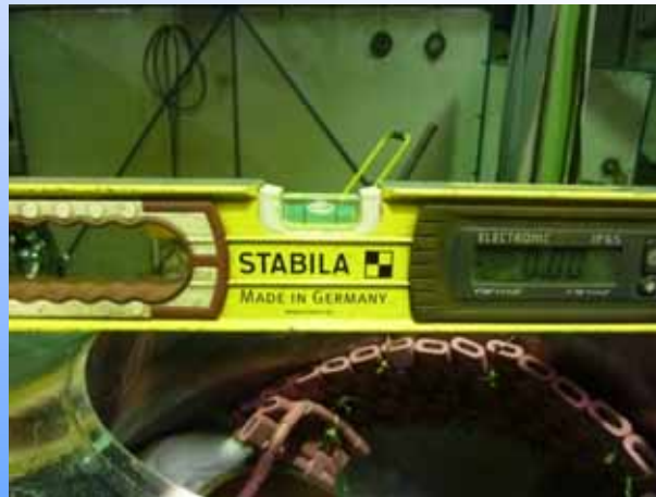
Einrichten und Abheften der Einzelteile unter Vorwärmung.
