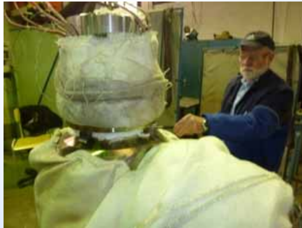
Kantenversatzkontrolle und Freigabe zum Schweißen mit BS und VE-G an der ersten Naht.
