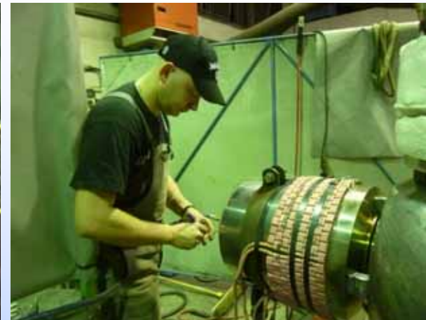
Einrichten und Abheften der Einzelteile unter Vorwärmung.
