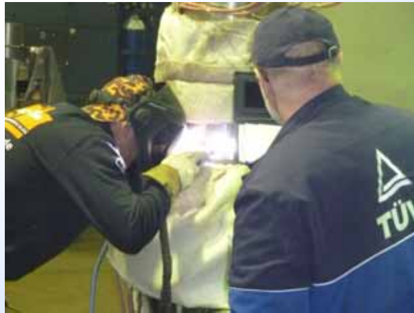
Beginn der Schweißarbeiten und visuelle Kontrolle der Wurzellage.
